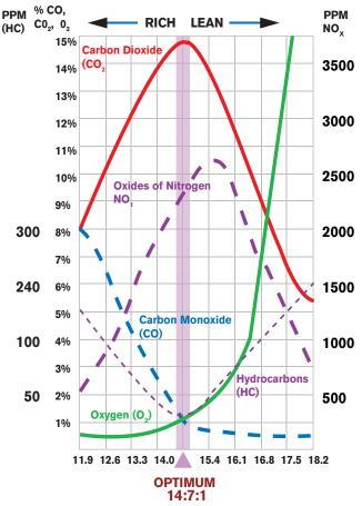
EXHAUST GAS LEVELS VERSUS AIR FUEL RATIO
