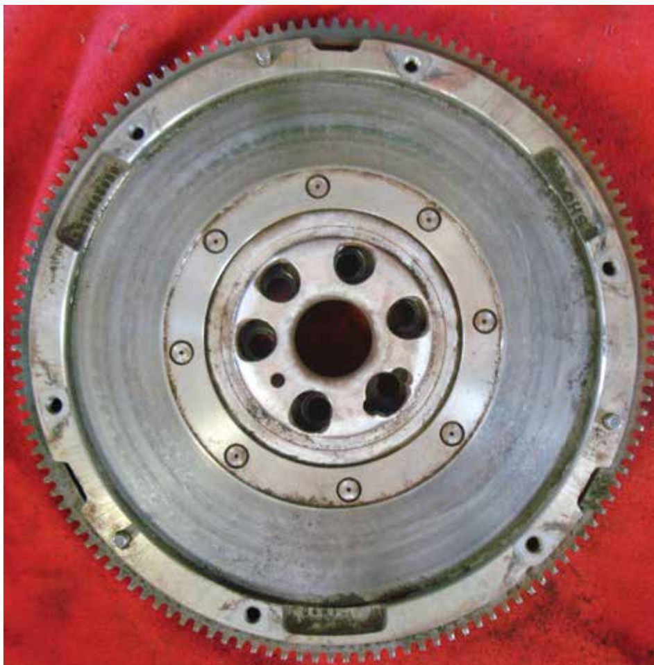
El plato volante Volkswagen (especialmente el plato volante doble-masivo) no pueden ser rectificadas. Hay que reemplazar el plato volante con una nueva unidad de su distribuidor de piezas de Volkswagen.
