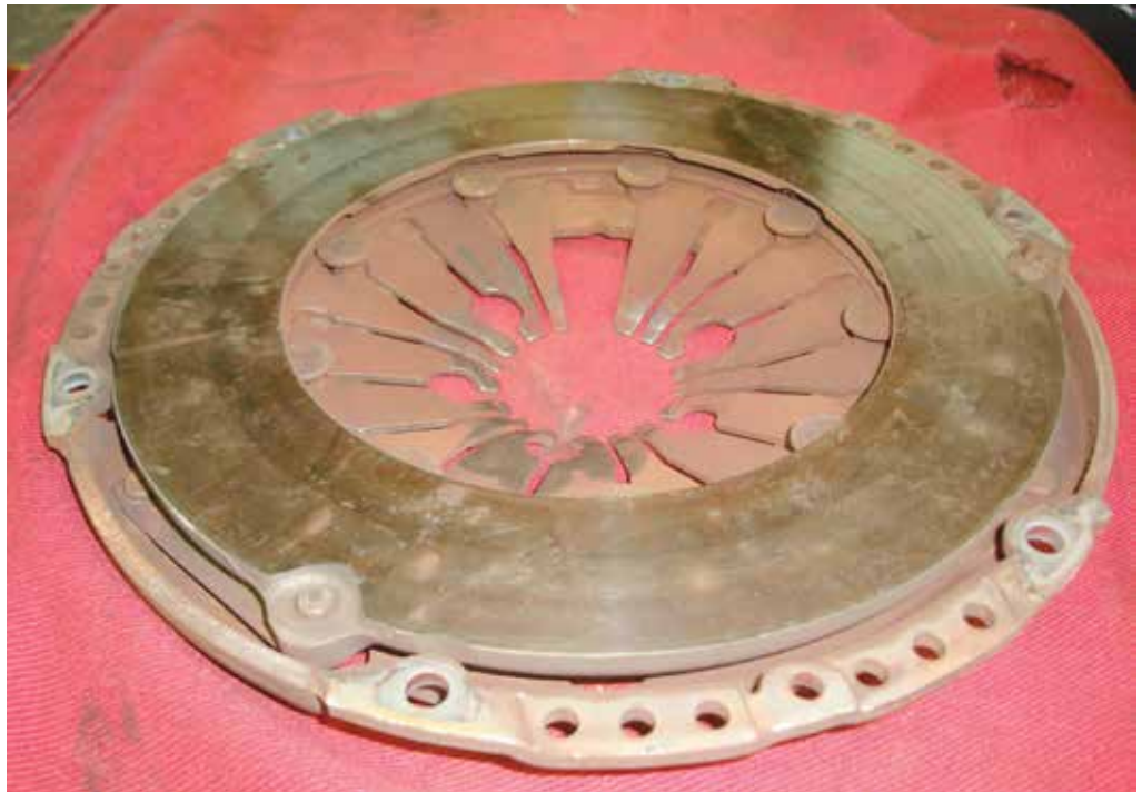
Uno de los resortes del plato de presión hace falta, que es una de las justificaciones para instalar siempre un plato nuevo cuando está en el área.
