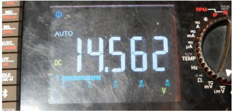
Correct alternator voltage using a volt meter
