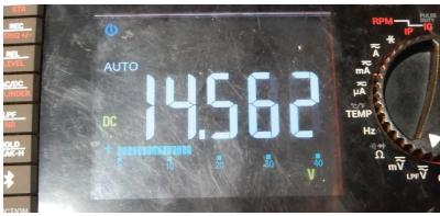
Correct alternator voltage using a volt meter
